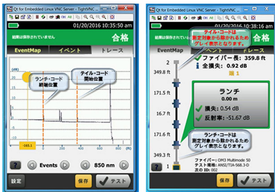
図 5-3: トレースには、テスト対象のリンクの始まりと終わりの部分のランチ・コードおよびテイル・コードが含まれます。右側に表示されている EventMap は、ランチ補正によってテスト結果からその影響を取り除いたものを示しています。
