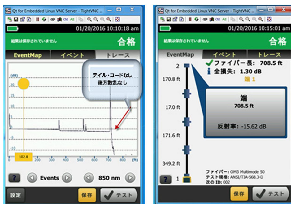
図 5-1: 最後のコネクタの性能を確認するには、テイル・コードが必要です。
