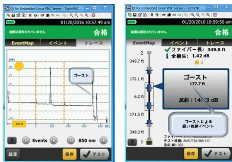
図 5-8: 「ゴースト」は、実在のイベントからの強い反射信号に起因する実際には存在しないイベントです。
