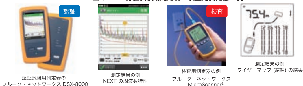
図 8.2.1 認証試験用測定器と検査用測定器の例
