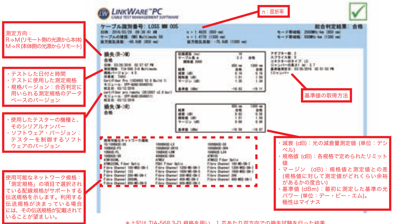
図 18.1 損失試験の試験成績書例
