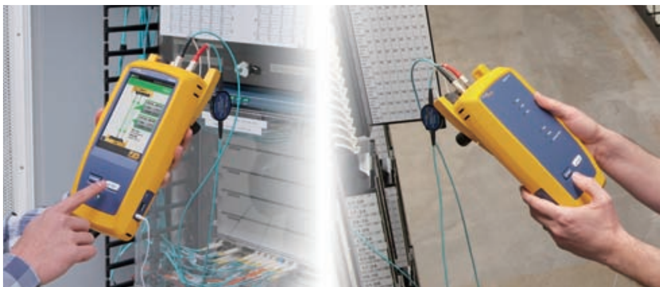
写真 19.3 2 芯光ファイバーの測定例
