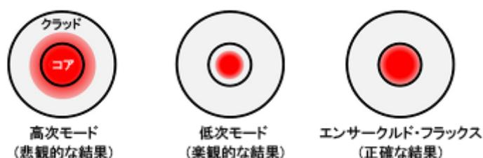
図 2. VCSEL 光源テスト - 悲観的な結果、楽観的な結果、正確な結果
