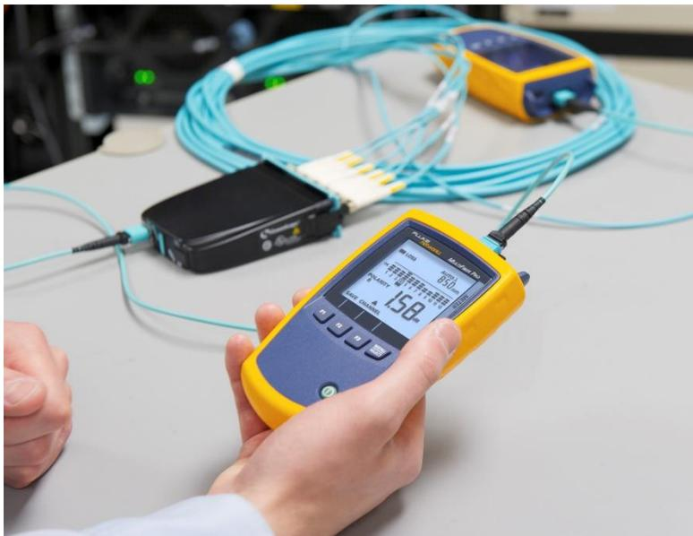
MultiFiber Pro を使用した MPO ケーブルのテスト例
