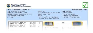
テスターのモデル、メイン・ユニットとリモート・ユニットのシリアル番号、テスターが最後に校正された年月日、 使用されたソフトウェアと規格バージョンも確認できます。残念なことに、既にテストを実行してレポートを印刷した 後となってしまいましたが、テスターの校正が行われてから 1 年以上が経過しています。
