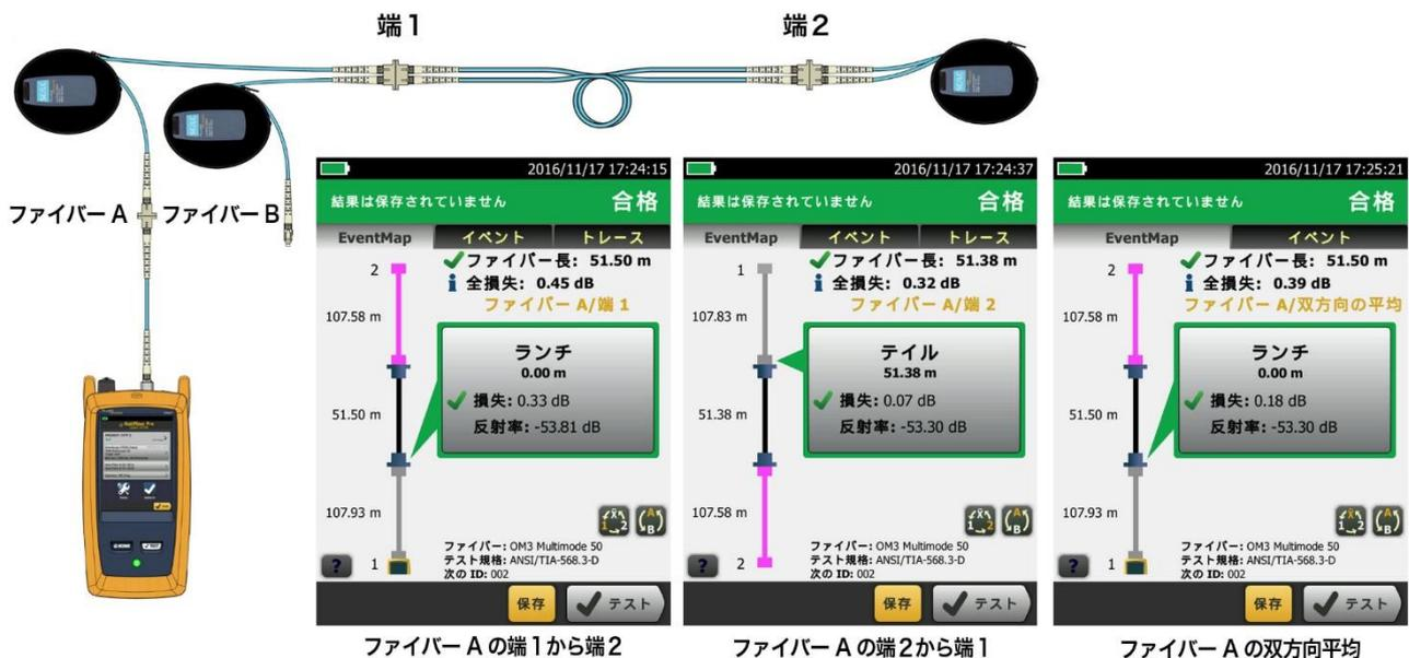
OptiFiber Pro の SmartLoop 技術によって、2本のファイバーを1度の操作で双方向テストが可能となり、各ファイバー・リンクの合否結果、双方向テスト結果の平均値を確認できます。
