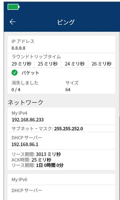
ピング・テスト結果画面では、4 回のピングごとにターゲットへの応答時間が表示されます。スクロール・ダウンすると、DHCP、DNS、ゲートウェイの情報が表示されます。
