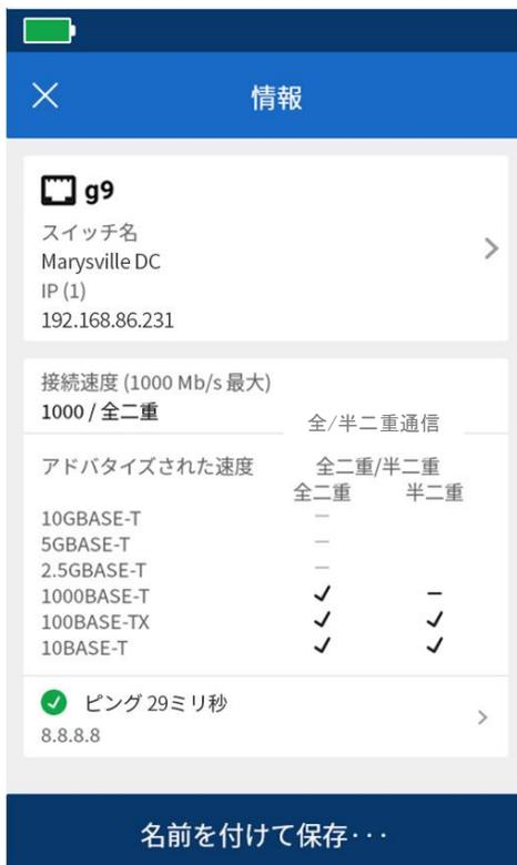
スイッチ・ポート・テストでは、ポート番号、スイッチ名、IP アドレス、ポート VLAN、およびアダプタイズされた速度とデュプレックス設定が表示されます。ピング・テストが設定されている場合は、ターゲット・アドレスと最大応答時間が表示されます。下にスクロールすると、PoE 試験結果が表示されます。
