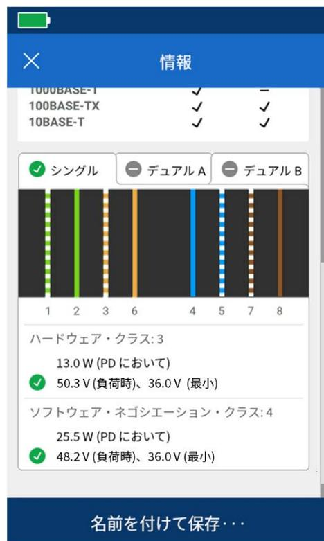
スイッチ・ポートのパワー・オーバー・イーサネット設定には、使用されているペア、使用可能な電力とクラス、および実負荷時の PoE 試験の結果が表示されます。
