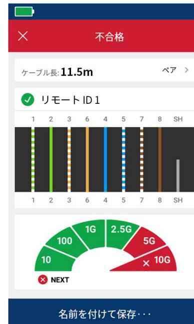
リモート ID を取り付けられた状態でのケーブル・テストでは、リモート ID の番号 1、各線の長さとしてワイヤー・ペア、および最大速度が 2.5Gbps であることが示されていますが、ユーザーが設定した 10Gbps の性能リミットによりテストが不合格となりました。
