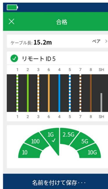
リモート ID が接続された状態でのケーブル・テストでは、リモート ID の番号 5、各ワイヤーの長さとしてワイヤー・ペア、最大 10Gbps のケーブル性能が表示されます。
