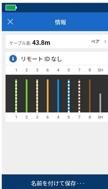
リモート ID が取り付けられていないケーブル・テストでは、各線の長さとしてワイヤー・ペアが表示されます。
