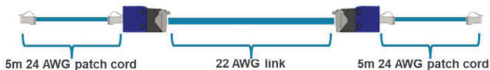
図 1: 合計 10 m の 24 AWG パッチコードを接続した試験対象の 22 AWG リンク
